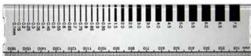
Bild 12 | Exempel på en sprickmall.
