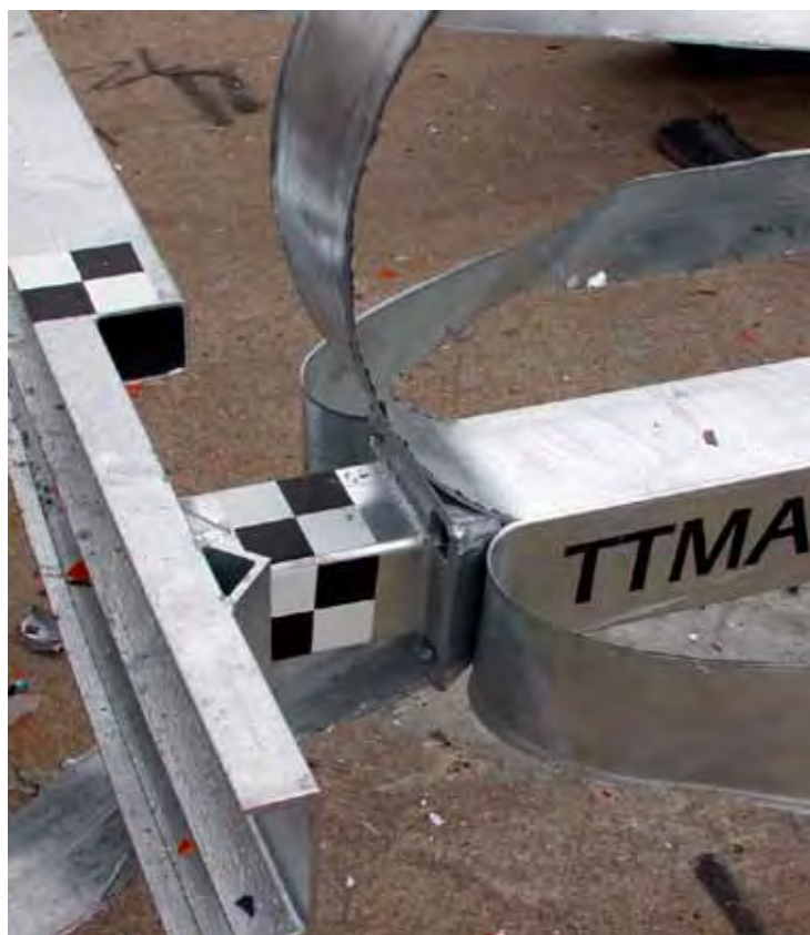
BILD 11: DE ENERGIABSORBERANDE RÖREN SPLITTRAS
