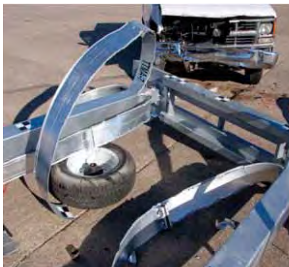
BILD 12: ÅVERKAN EFTER EN KOLLISION VID MEDELHASTIGHET
