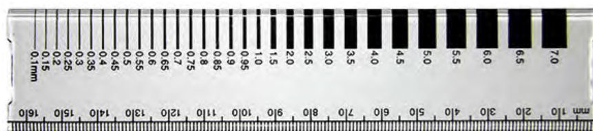
Bild 10 | Exempel på en sprickmall.
